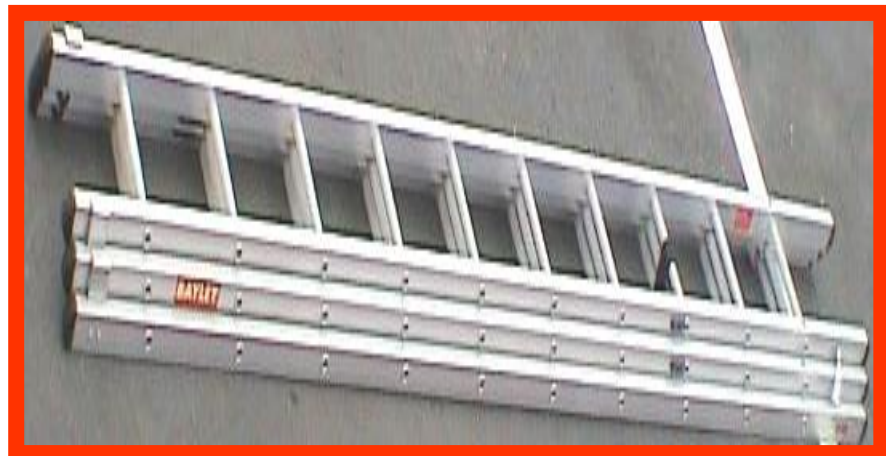
Gambarajah 7.3 : Tangga Sambungan 10.5 meter.
