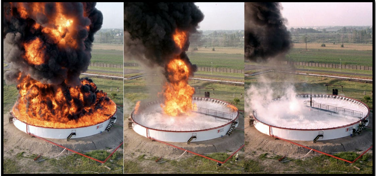
Gambar 6.3: Simulasi pemadaman kebakaran full surface fire dengan fixed system
