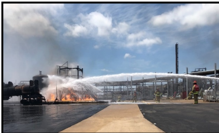
Gambar 7.2: Contoh pemadaman bund fire menggunakan mobile equipment
